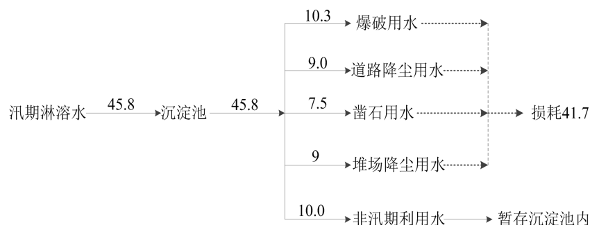
图 2 本项目汛期水平衡示意图 单位：m³/d
