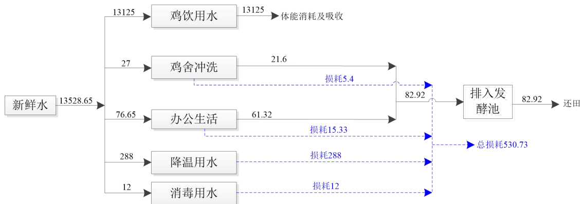
图 3.1-2 扩建项目年给、排水平衡图 单位: m³/a
