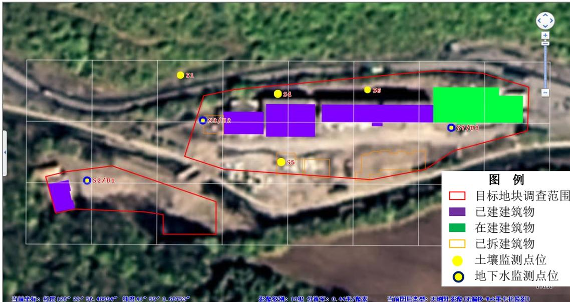
图 5-1 目标地块土壤和地下水监测点位布设情况示意图
